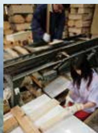
経節を削るように1ミリ厚(厚経木)にし、選別後、2枚ずつ貼り合わせ容器に加工
